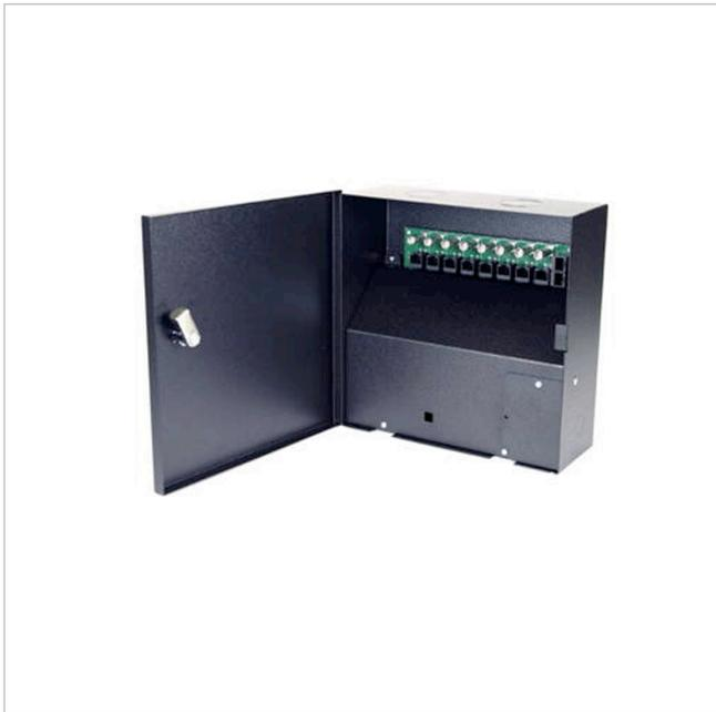
Video-, Spannungs- und Daten- Empfänger, 8 Kanal, passiv, RJ-45, BNC Ausgänge, 115VAC
