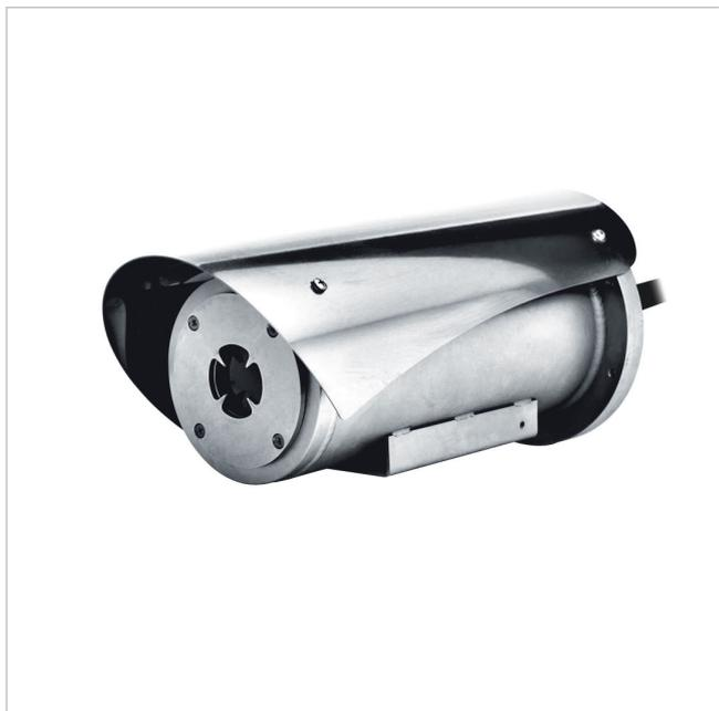
Wärmebildkamera, EX Gehäuse, Edelstahl, 336x256, 8,3Hz, 9mm, -60°C/+65°C, IP68
