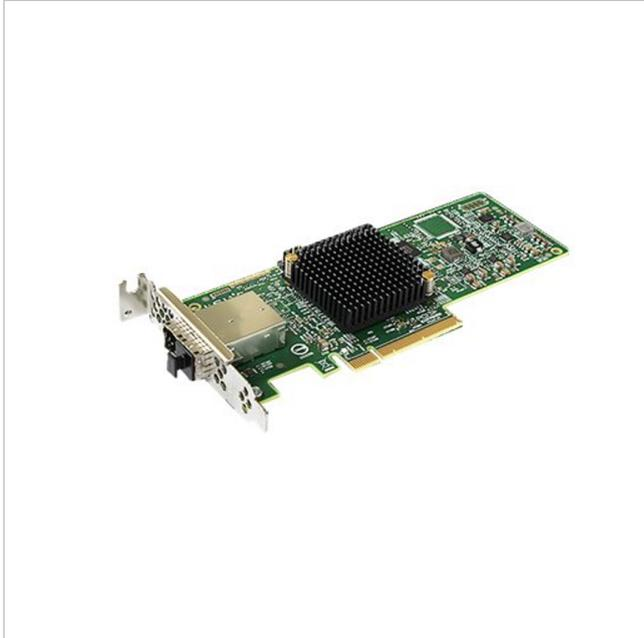
Speichererweiterungskarte, SAS, PCIe 3.0 8-lane, für FlashStation FS3017
