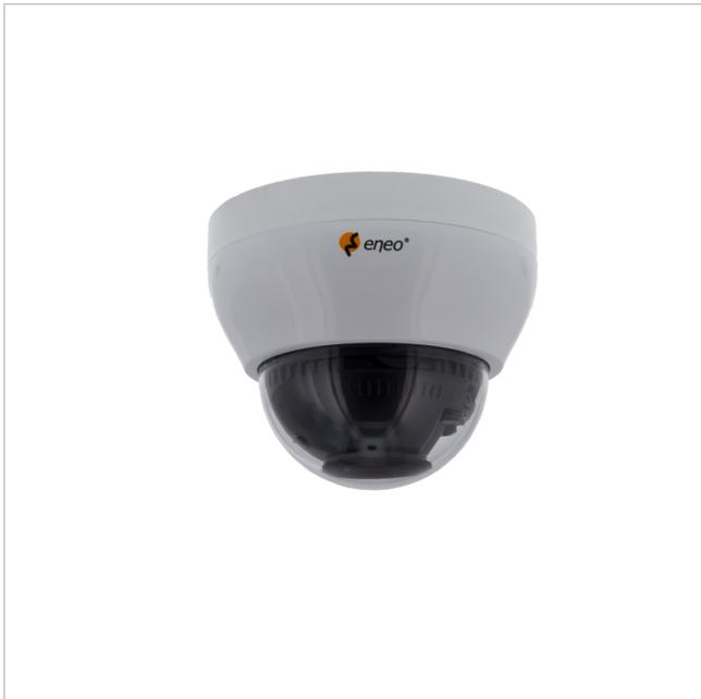
1/2,8" HD Dome, Fix, Tag/Nacht 1920x1080, Infrarot, 2,8-12mm, WDR, 12VDC, Innen
