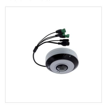
1/1,7" Netzwerk Dome, Fix, Tag/Nacht, 4000x3000, H.265, 1,29mm, 360°, IR-LED, IP66
