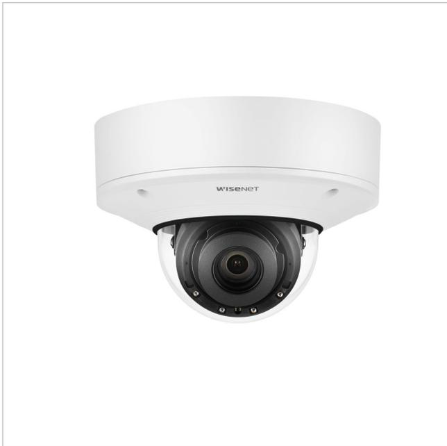
1/1,8" Netzwerk IR Dome, Fix, Tag/Nacht, 2,8-8,4mm, H.265, WDR, 3840x2160, IK10+, IP6K9K
