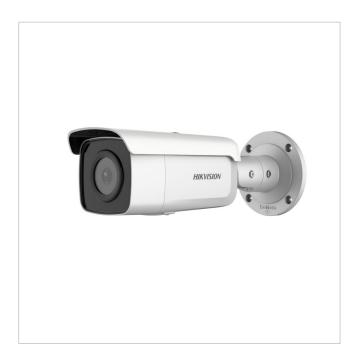
Netzwerk Bullet Kamera, Tag/Nacht, 2688x1520@30fps, 2,8mm, Infrarot 60m, IP67
