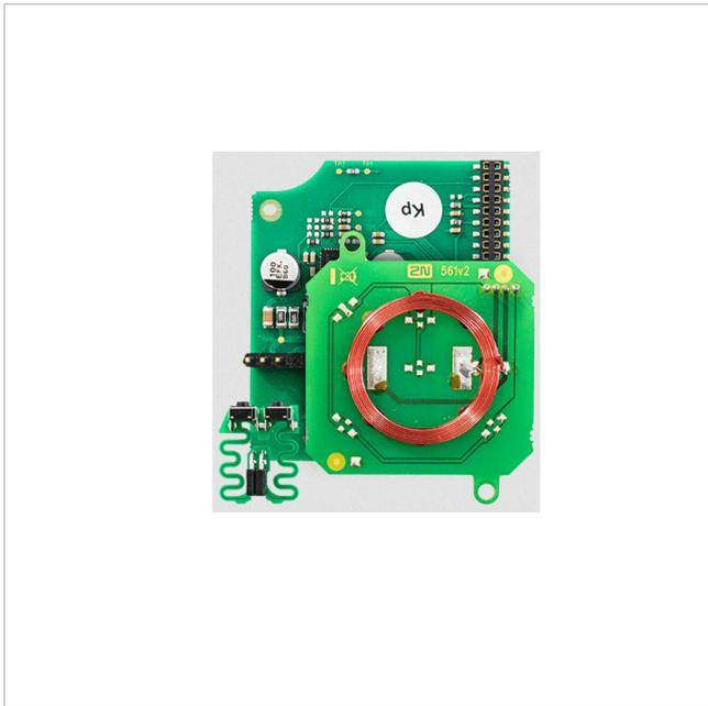
Induktionsschleife zur Drahtlos Übertragung an ein Hörgerät, für 2N IP Force
