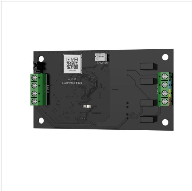
Modul zum Schutz vor Kurzschluss und Sabotage von Geräten auf der Fibra Leitung für Ajax Hub Hybrid
