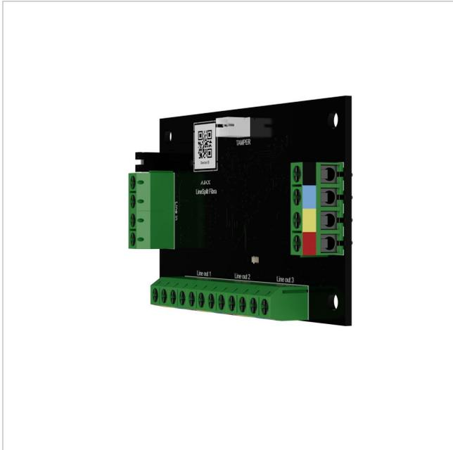
Modul zum Aufteilen einer Fibra Leitung in vier Leitungen für Ajax Hub Hybrid
