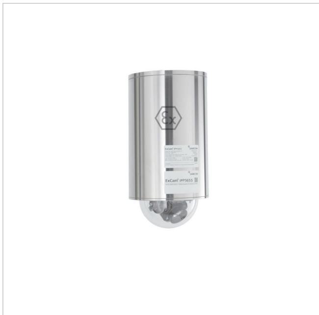
Netzwerkamera im Edelstahlgehäuse gemäß RL 2014/34/EU (ATEX) und IECEx, 1080p, 32x optischer Motor-Zoom, IP68, -30°C/+60°C
